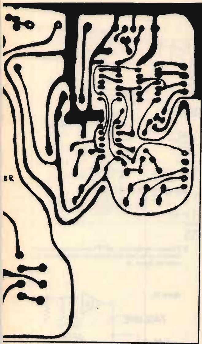
figura 7 Stampato lato rame (scala 1:1).
